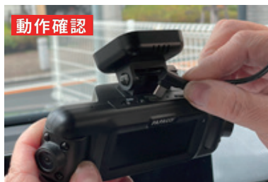
電源ケーブルを接続
