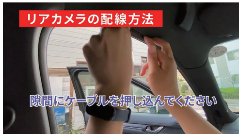
②隙間にケーブルを押し込んでください
