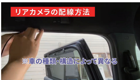
③センターピラーに配線
