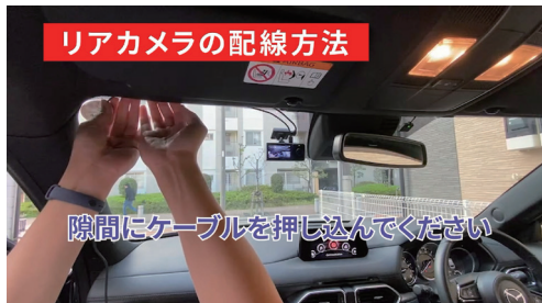
①隙間にケーブルを押し込んでください
