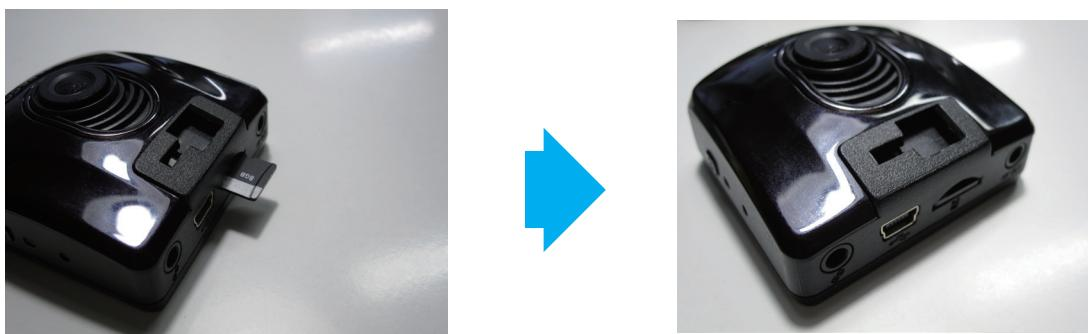
2.11 ドライブレコーダーを起動した後、電源スイッチ(LEDインジケータ)が点滅し、ファームウェア更新が自動的に開始されます。
