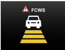
LDWS、FCWSの各機能はGPS信号の捕捉および記録画像から情報が必要です。夜間等明るさの不足により画像情報の不足するシーンやGPU信号受信が不安定になりがちな雨天時には検出精度が低下する可能性があります。あくまでも補助機能ですので、機能を過信せず安全運転につとめてください。FCWS、LDWS設定時は録画画面に枠線が表示され隨時測定されます。地図・時刻・速度&方位表示ではアイコン表示および音声での警告、録画画面表示中は音声での警告となります。
