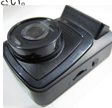
2.11 ドライブレコーダーを起動した後、LEDインジケータが点滅し、ファームウェア更新が自動的に開始されます。
